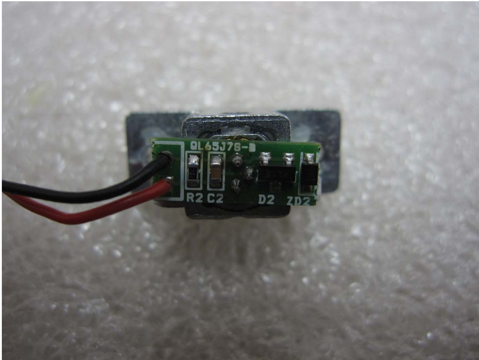
Magic Cube_IR Light Source Module PCB
